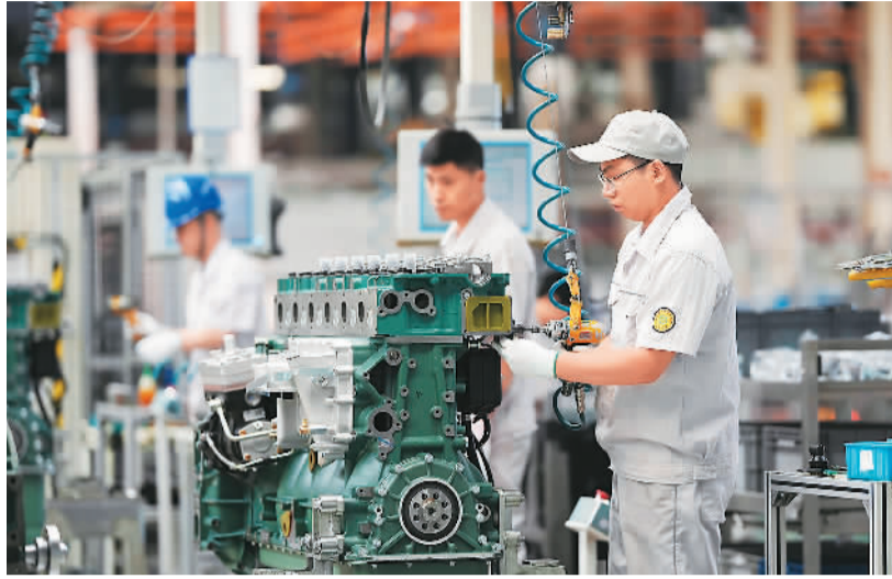
位于江苏省无锡市的一汽锡柴惠山工厂是一汽解放动力总成事业部投资建成的重型车用发动机生产基地，如今已成为引领行业的智能制造“超级工厂”，工厂机加线自动化率高达95%以上，装配线自动化率高达60%。图为6月3日，该厂工人在智能制造车间里工作。新华社记者 李 蕊摄
