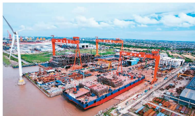
6月6日，由中文二航局投资、上海振华重工建造的双臂架幅式起重船“二航卓越”顺利下水，进入起重设备安装调试和交船冲刺阶段。该起重船最大起重重量5500吨，建成后将是国内同类型船舶中起重能力最大的双臂架幅式起重船。康朴 吴晨晨摄影报道
