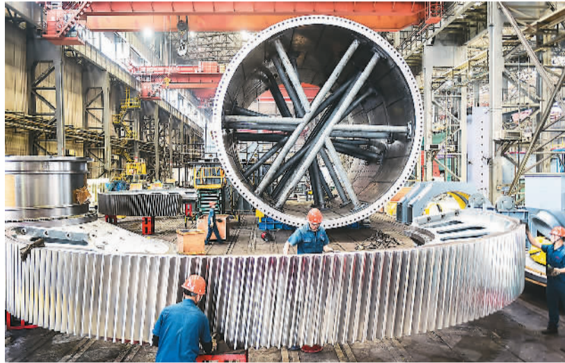
河南省洛阳市大力发展装备制造业，装备制造业规模化、集约化发展水平不断提升，助力当地经济高质量发展。图为日前，工人在位于洛阳市的中信重工车间内装配直径6米的矿用大磨机。
