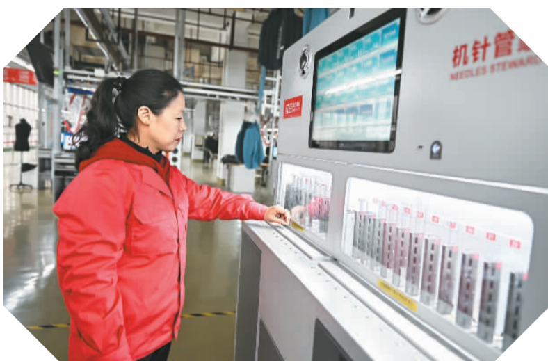
在位于江苏省无锡市锡山区的红豆股份红豆男装5G智能全连接工厂，工人通过“机针管家”进行菜单式自助换针。
