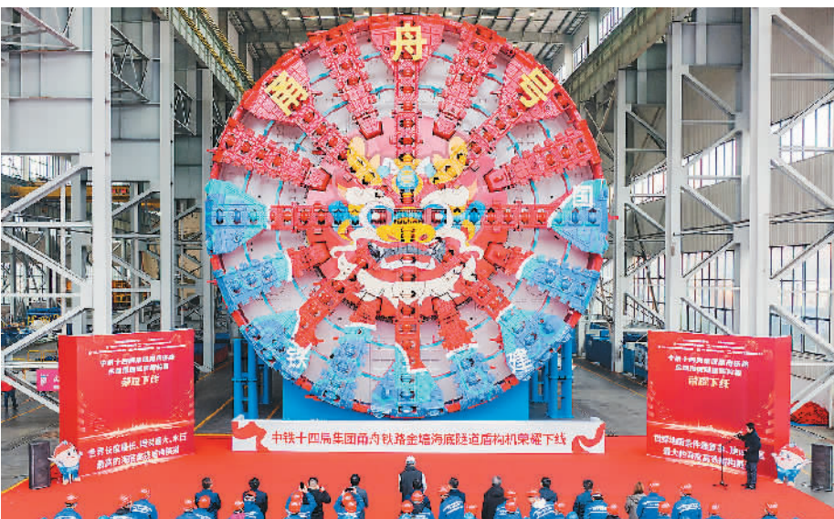
2月26日,由中铁十四局集团、铁建重工集团联合研发的超大直径盾构机“甬舟号”在湖南长沙下线。“甬舟号”全长135米,刀盘开挖直径14.57米,将应用于世界上最长海底高铁隧道——甬舟铁路金塘海底隧道建设。图为“甬舟号”下线仪式现场。 李健摄 (人民视觉)
