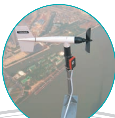
螺旋槳風速儀監測塔頂風速。
