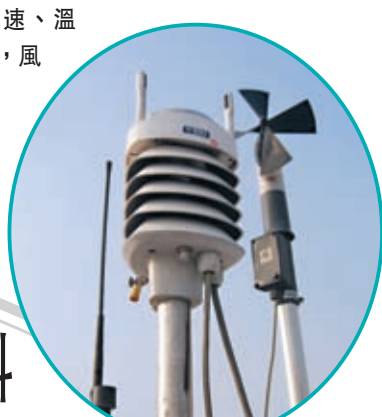
螺旋槳風速儀監測塔頂風速。
