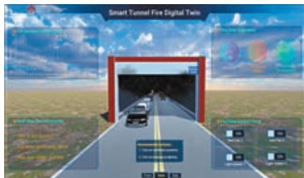
◆港理大團隊設計了一個數字孿生監測系統，在看不見隧道內實際狀況時亦能進行風險監測。
