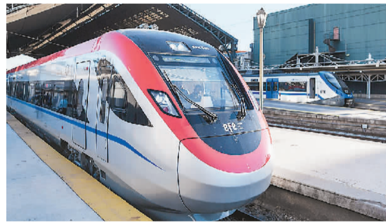
中车四方股份公司为智利研制的电力内燃双动力动车组近日在智利投运。该动车组最高运行时速160公里，是目前南美洲最快的轨道列车。图为动车组停在圣地亚哥中央车站。豪尔赫·比列加斯摄（新华社发）
