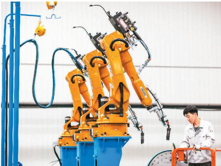
唐山开元自动焊接设备有限公司组装车间工人在调试焊接生产设备。 董 军摄
