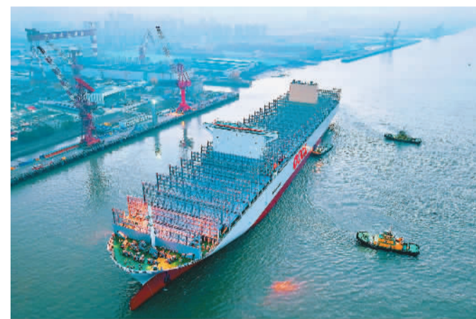
1月9日，由江苏南通中远海运川崎船舶工程有限公司自主设计制造的全长最大集装箱新造集装箱船“中远川崎396”开启试航，顺利离开长江南通段驶往东海北部海域。该船长399.99米，型宽61.3米，一次可装载24188只标准集装箱。
