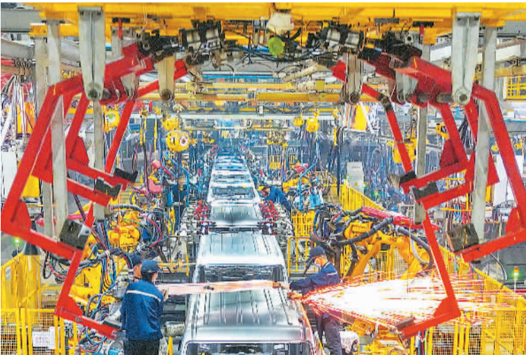
在江西省赣州市经济技术开发区一家新能源汽车制造公司冲焊生产线上,工人们进行焊接作业。 李 劭摄(人民视觉)
