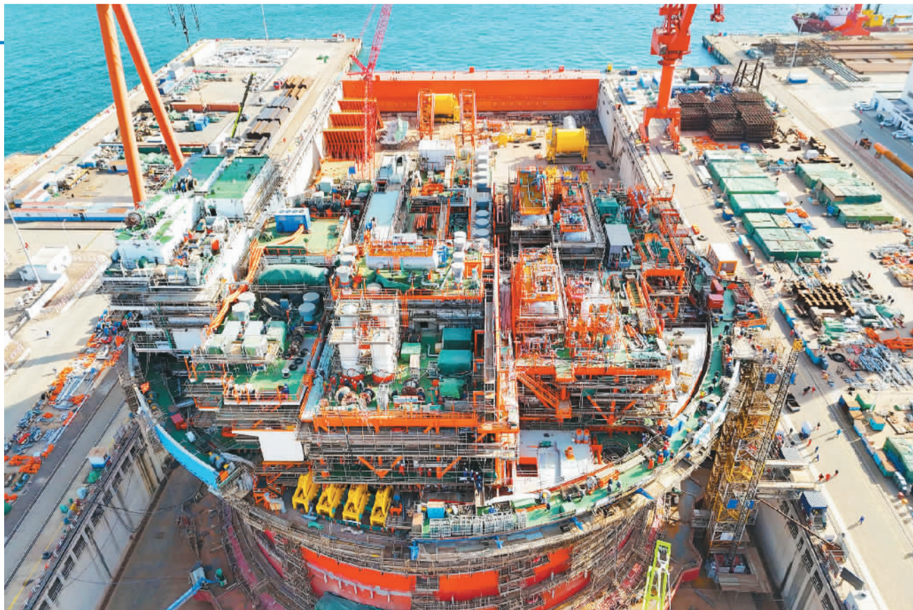
12月6日, 中国自主设计建造的亚洲首艘圆筒型“海上油气加工厂”——“海洋石油122”浮式生产储卸油装置(FPSO)在山东青岛完成主体建造。“海洋石油122”主体最大直径约90米, 总重约3.6万吨, 设计排水量10万吨, 最大储油量达6万吨, 设计寿命30年, 可连续在海上运行15年不回坞。图为当日, “海洋石油122”主体建造在青岛完工。
