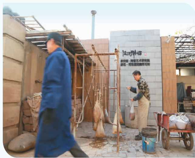
◀ 工作人员对澄滤后的黄河泥进行脱水。
