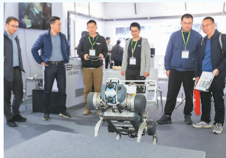
十一月十五日，在上海国际电力设备及技术展览会上，工作人员演示搭载热成像双光谱云台的四足机器人爬楼梯巡检。 新华社记者 王翔摄
