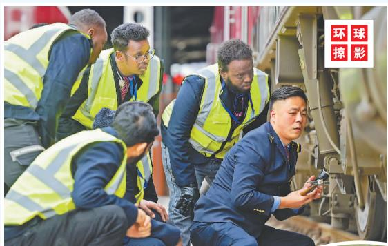
本报电(朱佩娴、赵晶晶)11月10日,来自亚吉铁路的 28 名学员在国铁集团郑州局郑州机务段机车整备场进行实操 训练。中国指导司机带队学习检查机车走行部,学习检查 HXD1D型机车的车轮轮盘、轮毂、撒砂管以及各类设备的 螺丝状态,为保证学员进行亚吉铁路运维和优化机车检修技 术打下基础。
