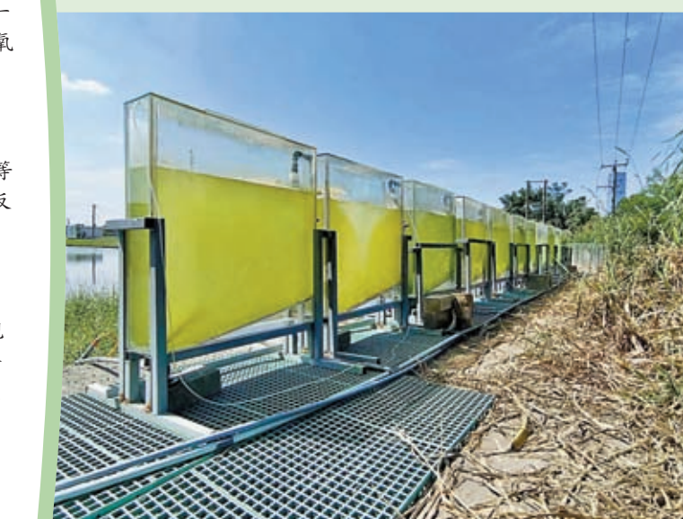
◆藻碳科技團隊在香港元朗建設的微藻反應器示範場。 香港文匯報廣州傳真
