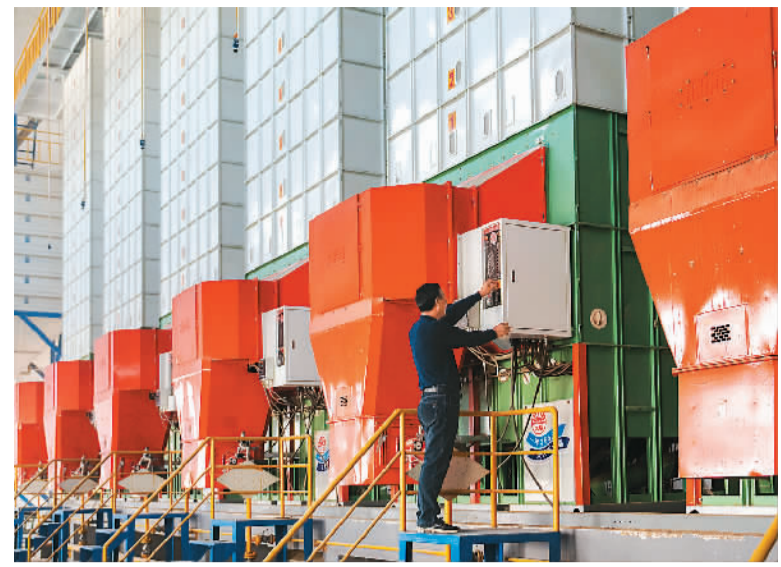
近期,湖南省益阳市南县42万亩中稻收割接近尾声,在南县南洲桥国家粮食储备中心,一辆辆满载秋粮的货车忙着称重、卸货。南洲桥国家粮食储备中心占地3.4万平方米,各类粮仓容量达2.5万吨。图为南洲桥国家粮食储备中心内,工作人员在操作烘粮设备。新华社记者 陈思汗摄
