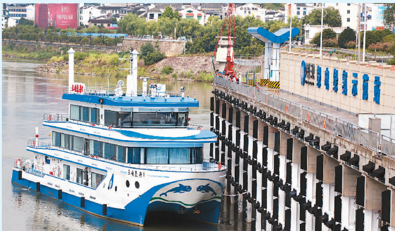
“三峡氢舟1”号自主航行至绿电绿氢示范站准备进行受氢作业。 梁强摄 (人民视觉)
