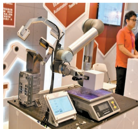
LSCM 物流高峰會「會場展示」的自動混凝土磚測試系統。 記者 蔡文攝
