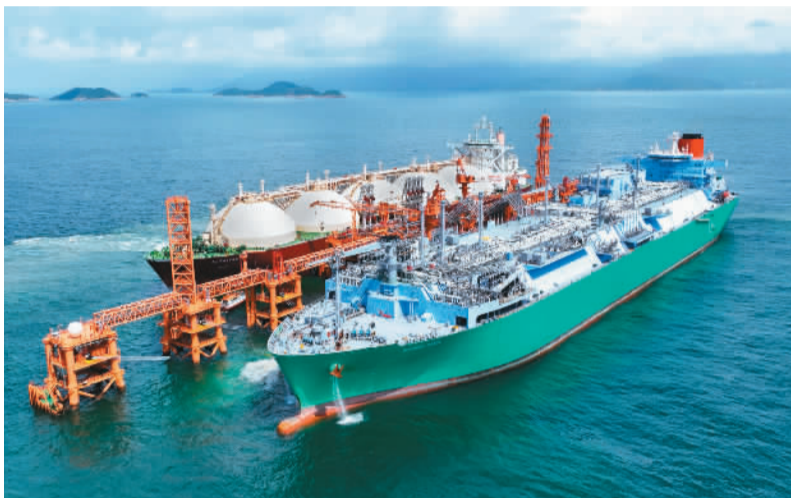
浮式储存再气化装置船“紫荆精神号”停泊在接收站,用于接收、储存及将液化天然气再气化。中华电力有限公司供图
