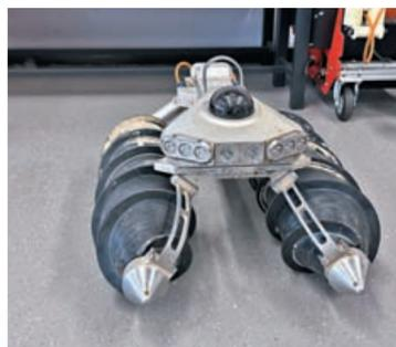
▶團隊研發可在管道滿水情況下進行作業的外水檢測機器人。
