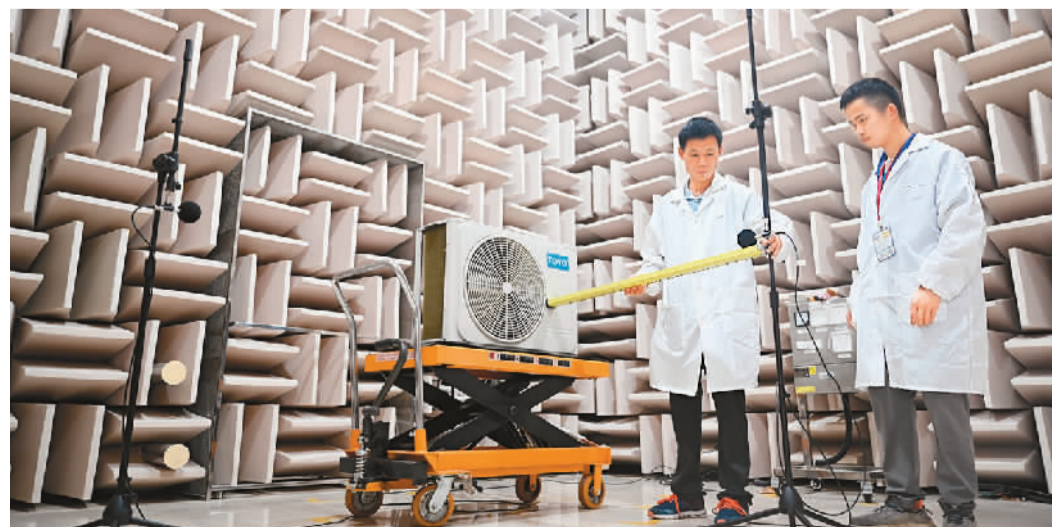
柳州市柳江区大力发展智能家电产业,目前已经引进智能家电企业29家,智能家电逐步成为柳江区规模以上工业经济增长的主力军。图为技术人员在柳江区一家空调企业的实验室里对即将上市的产品开展噪音测试。
