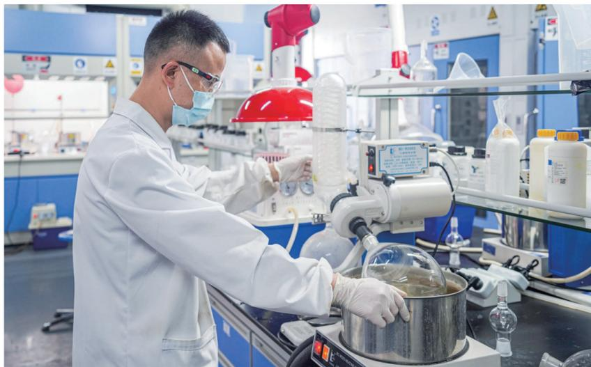
伏安光電研發人員正在進行材料濃縮與純化。
