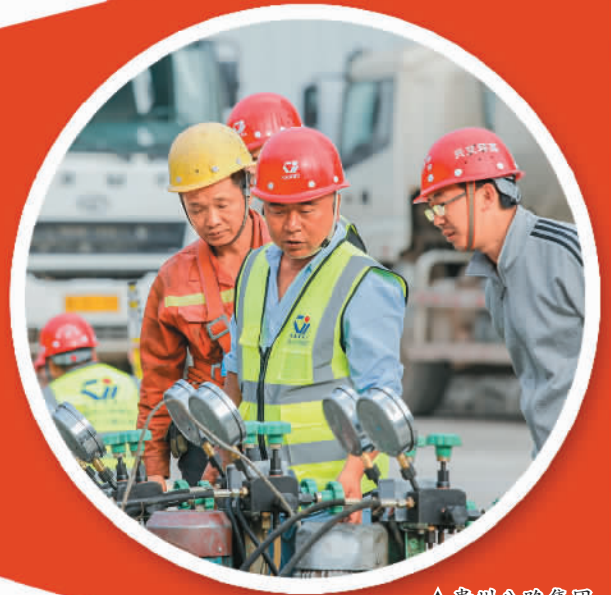
▲贵州公路集团桥梁建设者在开展贝雷片荷载试验。
