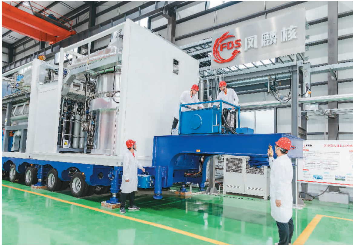
“核电宝”是“凤麟核”创新团队的核心项目之一。这是一种具有固有安全性、采用特种液体金属作为冷却工质的紧凑型先进核能系统,具有超安全、超小型和超长效的技术特点,设计寿命三十年到六十年。图为十兆瓦级车载“核电宝”工程集成模拟试验样机。受访者供图
