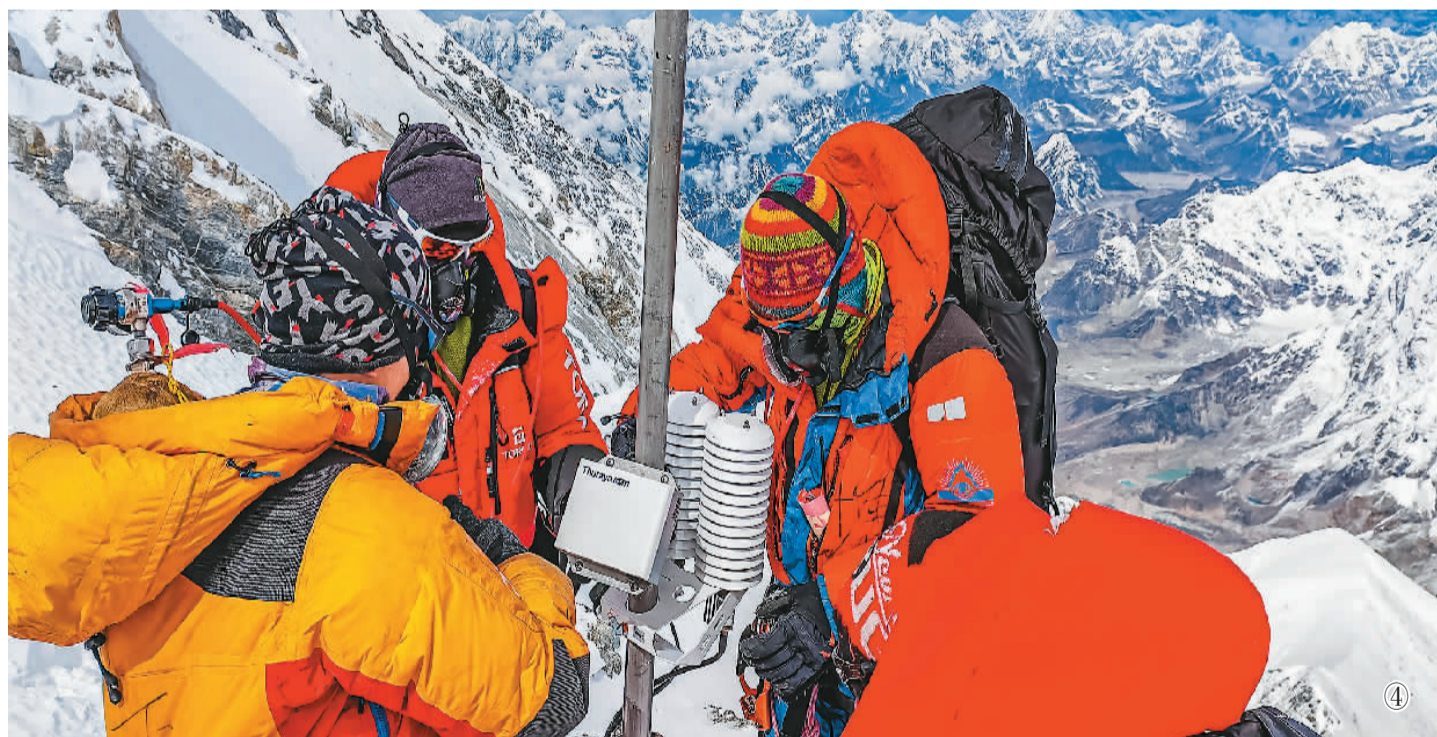
图④：科考登顶队员在珠峰海拔约8830米处维护升级自动气象站。
