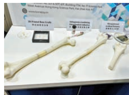
膏狀的材料可以3D打印預先製成支架，塑成適合傷處的形狀。
