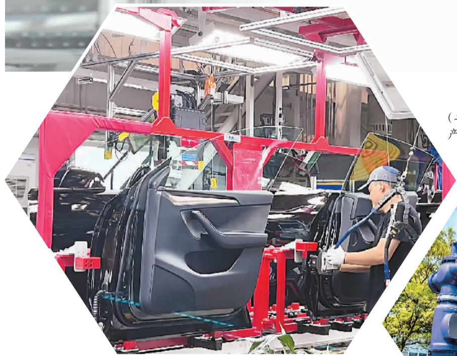
▲特斯拉上海超级工厂的工人对车门进行装配。本报记者 孔德晨摄
