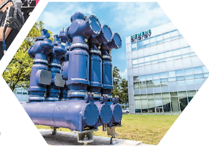
▲上海西门子高压开关有限公司的厂区内，矗立着该公司研发的西门子能源气体绝缘开关设备(GIS)。西门子能源供图
