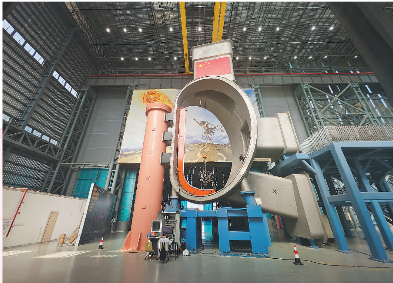
聚变堆主机关键系统综合研究设施1/8真空室及总体安装实验平台。
