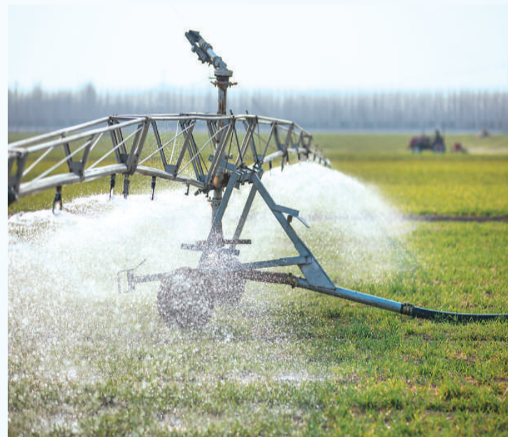
▲在山东省东营市广饶县乐安街道春英家庭农场，大型喷灌机按照设定参数自动地进行麦田浇水。 刘云杰摄（人民视觉）
