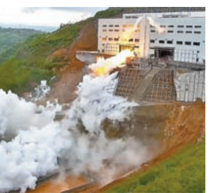
4月24日，亞洲最大推力700噸液體火箭發動機試驗台考台試車在陝西銅川取得圓滿成功。中國航天六院
