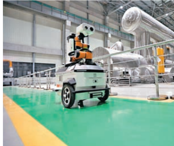
◆電影中的移動機械人於現實的傳統能源火電廠中執行智能巡檢任務。網上圖片
