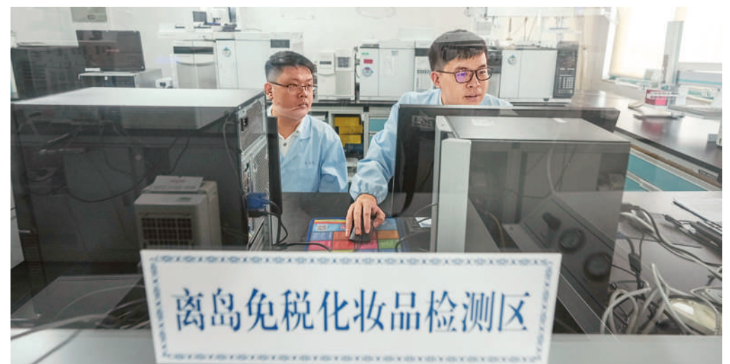
在海南离岛免税化妆品检测区，检测人员使用气相色谱质谱联用仪分析免税化妆品中禁用限组分检测结果。
