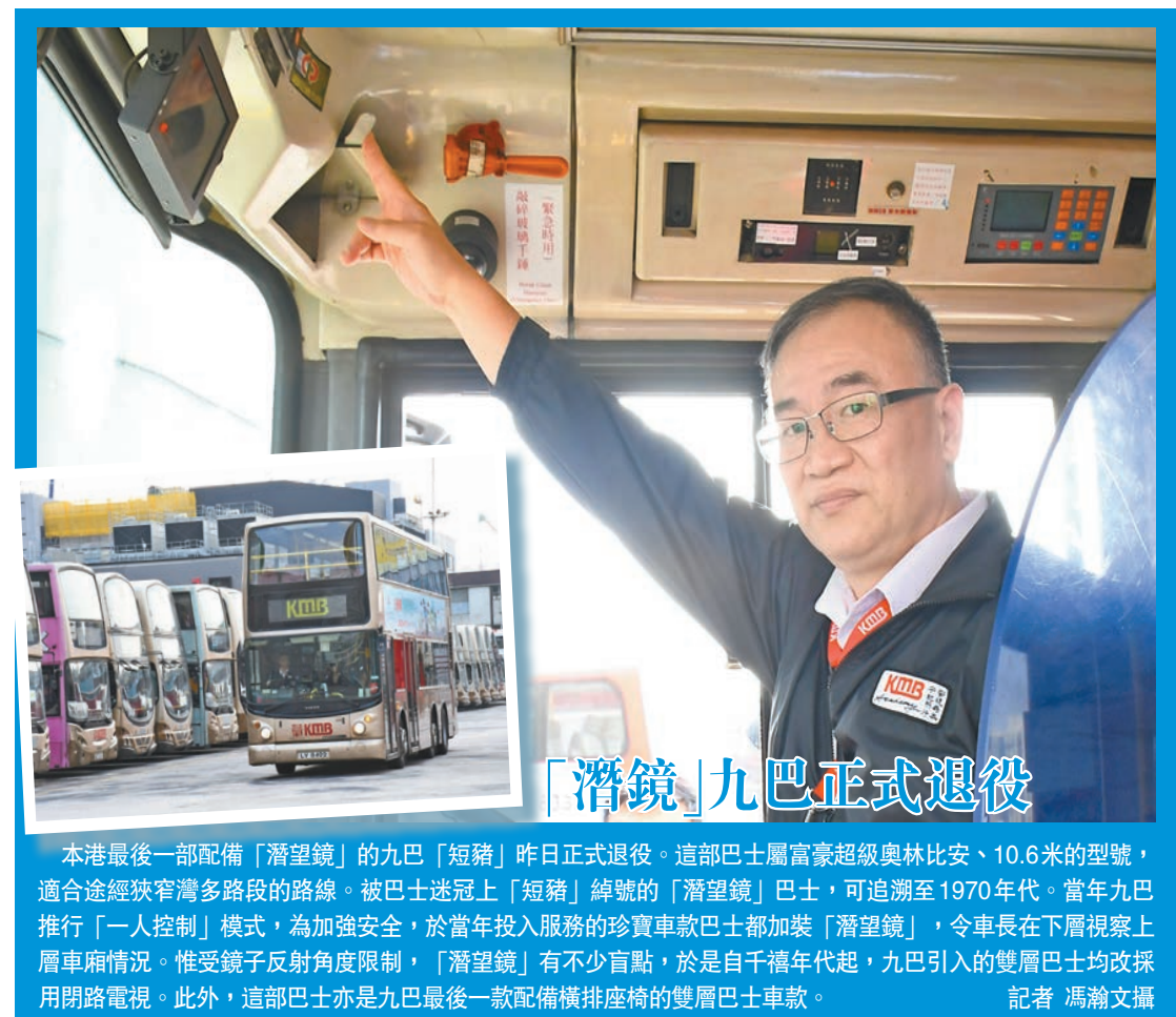
本港最後一部配備「潛鏡」的九巴「短豬」昨日正式退役。這部巴士屬富豪超級奧林比安、10.6米的型號，適合途徑狹窄灣多路的路線。被巴士迷冠上「短豬」綽號的「潛鏡」巴士，可追溯到1970年代。當年九巴推行「一人控制」模式，為加強安全，於當年投入服務的珍寶車款巴士都加裝「潛鏡」，令車長在下層視察上層車廂情況。惟受鏡子反射角度限制，「潛鏡」有不少盲點，於是自千禧年代起，九巴引入的雙層巴士均改採用閉路電視。此外，這部巴士亦是九巴最後一款配備橫排座椅的雙層巴士車款。記者 馮瀚文攝
