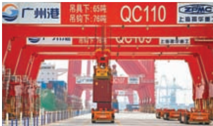
◆在廣州港全自動化碼頭，岸橋精準抓取集裝箱放置在北斗導航無人駕駛智能車上。
