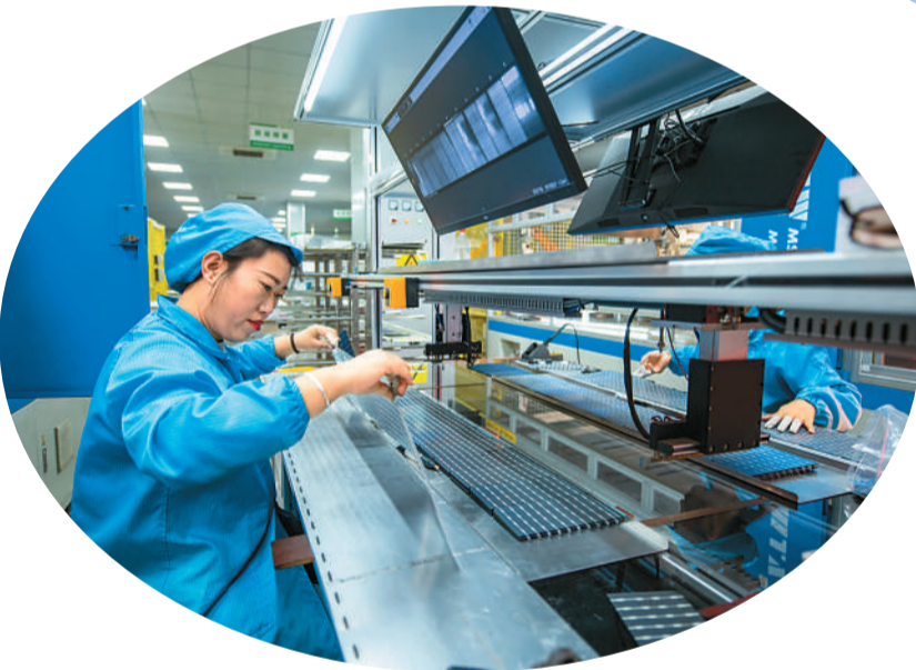
▲浙江格普光能科技有限公司从事太阳能电池片、光伏组件等研发、生产和销售，今年以来，公司订单大幅增加，生产车间一派忙碌景象。图为2月14日，公司技术人员在对光伏组件进行单片质量检测校验。 胡肖飞摄（人民视觉）
