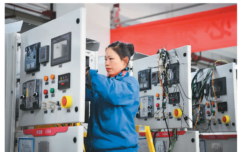
近日，在位于陕西省西安市的西安高新区草堂科技产业园、泾渭新城等重点工业园区，陕汽控股、隆基绿能等行业龙头企业以及部分“专精特新”企业早复工、抢开局，订单量较去年同期普遍增长，企业生产经营态势向好。图为工人在西安西驰电气股份有限公司生产基地装配高压软启动器。
