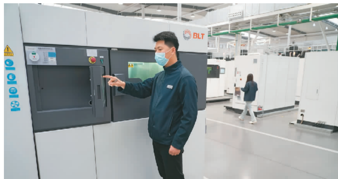
工作人员在位于西安高新区的铂力特金属增材制造智能工厂项目车间内操作3D打印设备。
