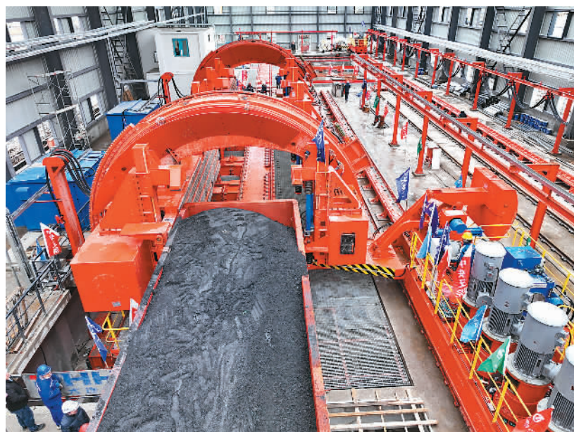
1月15日，由江苏省南通市沿海集团承建的洋吕铁路东灶港站物流项目输煤系统重载联调顺利完成。项目建成后，可保障中钢铁600万吨/年的煤炭运输任务。
