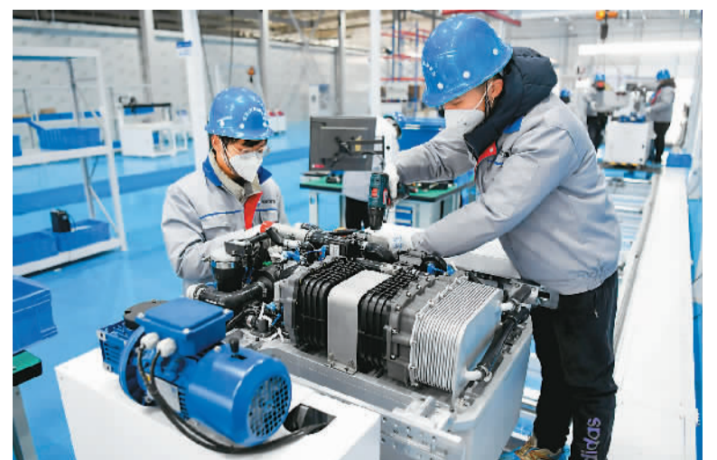
东旭氢能电机装备产业园项目是河南省洛阳市大力发展氢能产业的标志性工程。目前，该项目氢燃料电池发动机项目生产厂房已全部建成，生产设备已调试完成，并开始试生产。图为该项目氢燃料电池发动机生产车间内，工作人员正在生产线上组装氢燃料电池发动机。张怡熙摄（人民视觉）
