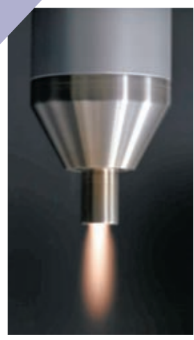
▲彭姣團隊研發的常規直噴式等離子體清洗設備。
