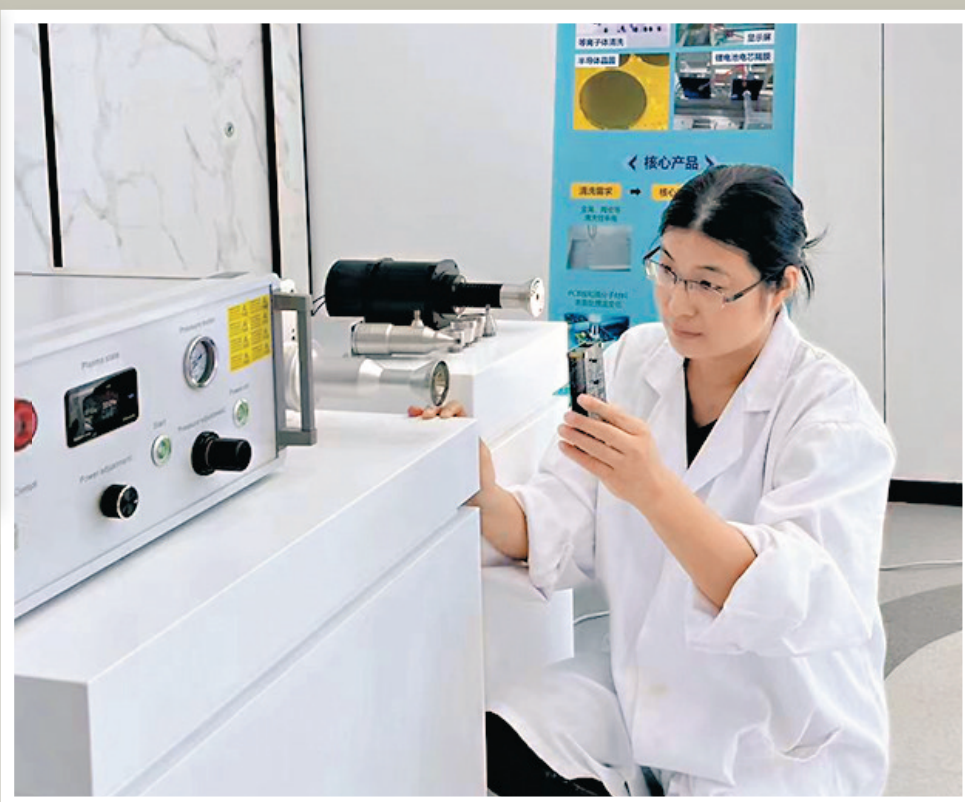
▲彭姣團隊研發的旋噴式等離子體清洗設備。
