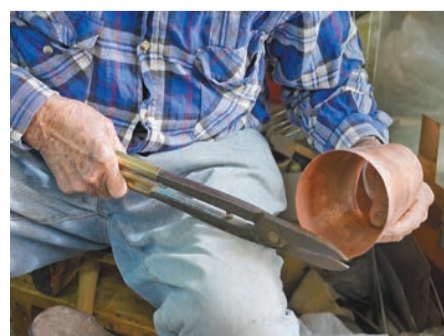
銅片的質地較以往硬，進行裁剪、切割等工序要花更多氣力。
