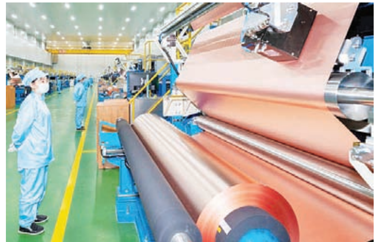
位於梅縣區的嘉元科技主要研發製造銷售高性能電解銅箔，圖為該企業銅箔生產一線。 連志城攝
