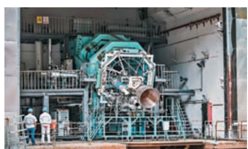
◆中國唯一一個百噸級液氧甲烷火箭發動機試車台已投入使用。 受訪者供圖
