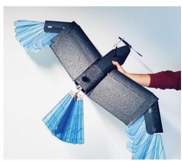
鸟形无人机特写,蓝色为可以变形(伸展和收起)的人造羽毛翅膀和尾部。 Enrico Ajanic 摄
