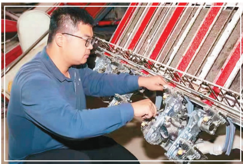
丁旦在检查水稻高速插秧机的插针状况，确保早稻机插秧环节能够正常高效工作。受访者供图
