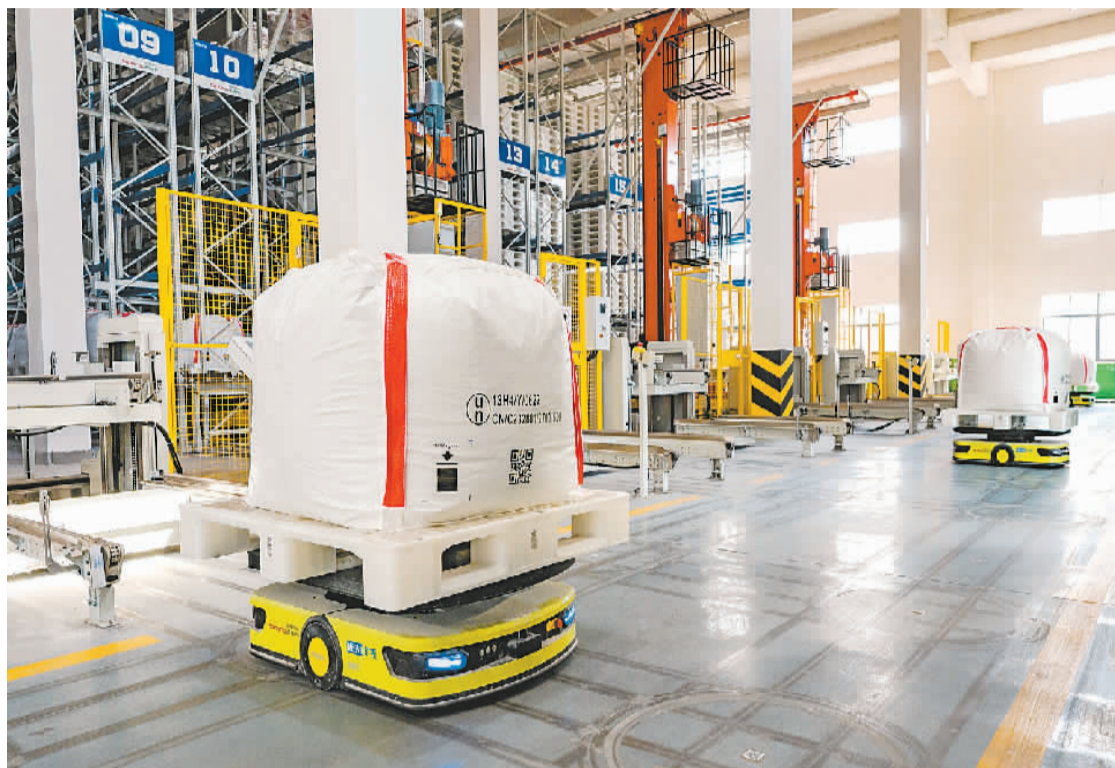
江西省新余市高新区通过支持企业利用现代数字信息技术、人工智能技术等对产业进行全方位、全链条改造，促进锂电、光伏、智能制造等重点行业数字化转型。图为在高新区锂电新能源产业园赣锋锂电的车间内，AGV转运机器人在智能程序下执行打托备货工序。赵春亮摄（人民图片）
