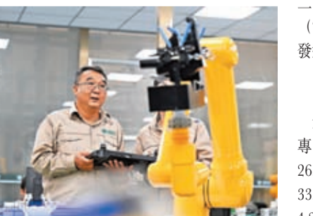
◆國家電網天津公司員工在調試第四代配網帶電作業機器人。
