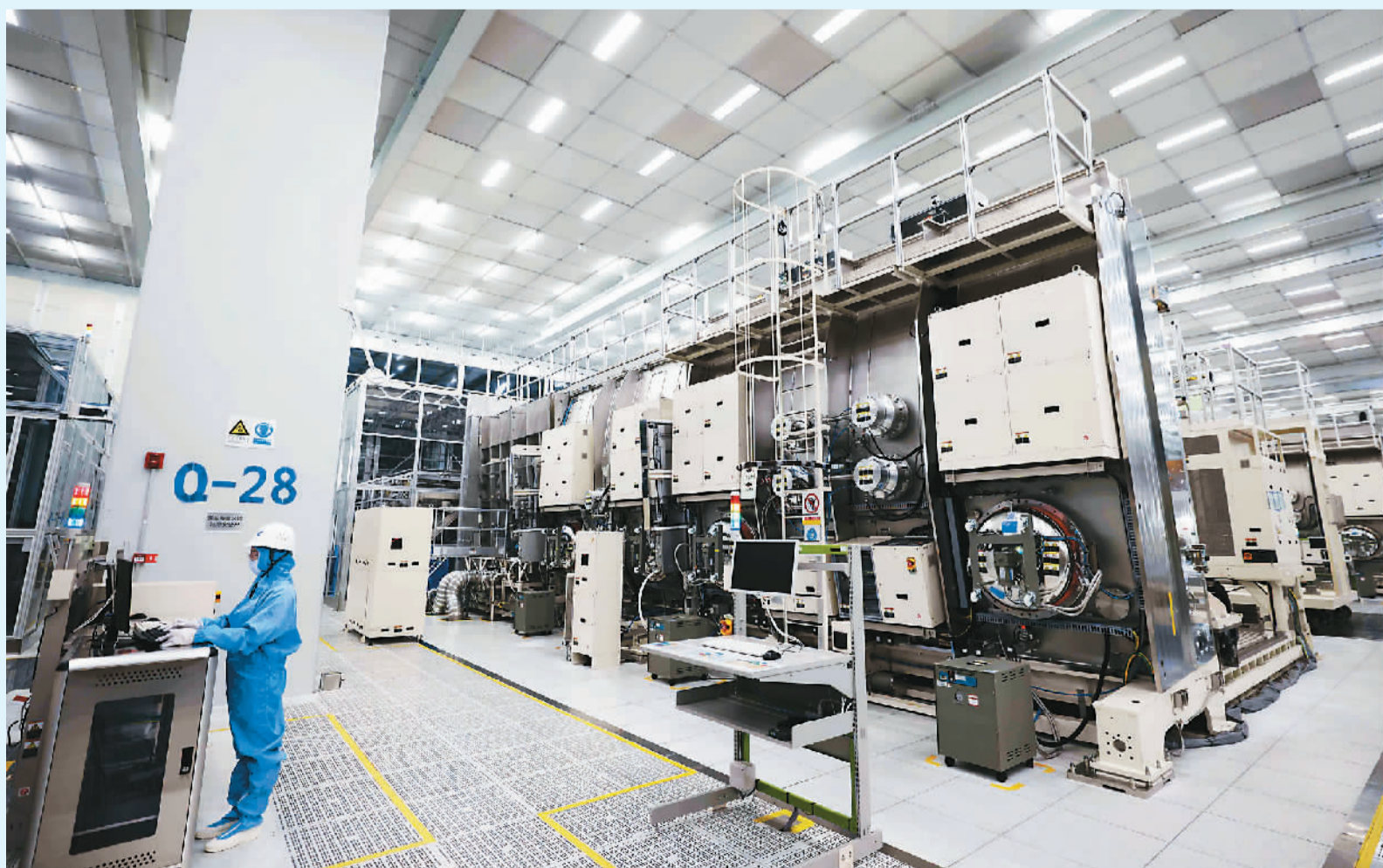
在安徽省合肥市新站高新区的合肥京东方显示技术有限公司的智能工厂内，依托于工业互联网的高新生产线有序运转，自动化设备精准地完成玻璃基板的传输、加工、检测等生产全过程。
