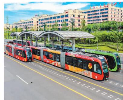
智轨电车由中国自主研发，不用钢轨和管轨，车辆借助轨道跟随等技术行驶，是一种新型绿色交通工具。图为在四川省宜宾市三江新区，智轨电车正在充电。
